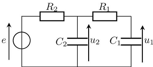
On se place en régime sinusoïdal forcé à la pulsation  $\omega$ . La tension  $u_1(t) = U_{10} \cos(\omega t + \varphi)$  est représentée par  $\underline{u}_1(t) = U_{10} e^{j(\omega t + \varphi)}$  où  $j^2 = -1$ .
