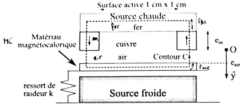
FIGURE 4 – Structure du thermogénérateur magnétique dans une position quelconque.
