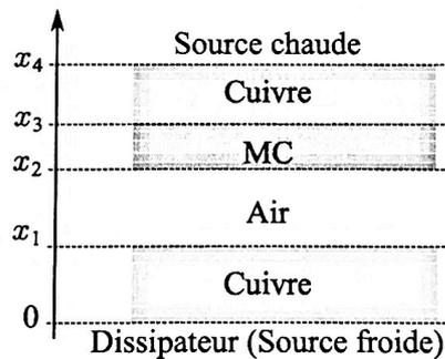
FIGURE 8 – Modèle thermique unidimensionnel du thermogénérateur.
