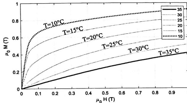
FIGURE 3 – Caractéristiques  $\mu_0 M(T)$  en fonction de  $\mu_0 H(T)$  d'un matériau magnétocalorique, la légende indique la température en °C du matériau.
