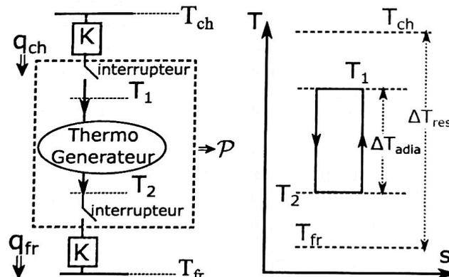
FIGURE 1 – (figure de gauche) Description schématique d'un générateur thermomagnétique en prenant en compte un modèle d'échange avec les réservoirs. Les interrupteurs thermiques représentent le fait que la substance active du système est alternativement en contact avec le côté chaud à  $T_1$  et le côté froid à  $T_2$ ; (figure de droite) Représentation graphique du cycle thermodynamique endoréversible dans un diagramme  $(T, S)$ .
