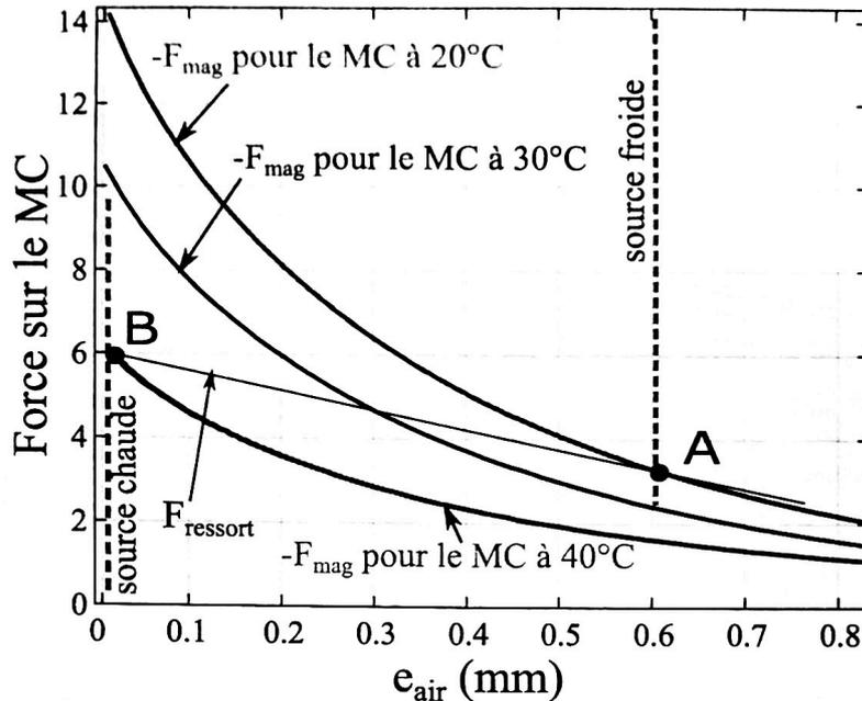
FIGURE 6 – Représentation graphique de la force du ressort  $F_{\text{ressort}}$  et de l'opposé de la force magnétique  $-F_{\text{mag}}$  appliquées sur le matériau magnétocalorique, en projection sur l'axe  $Oy$  de la figure 4.
