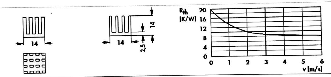
FIGURE 10 – Extrait de la documentation technique du dissipateur.
