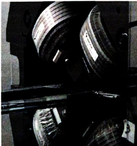
**Figure 2a)** Quadrupôle, d'après Reflets de la physique n° 34
