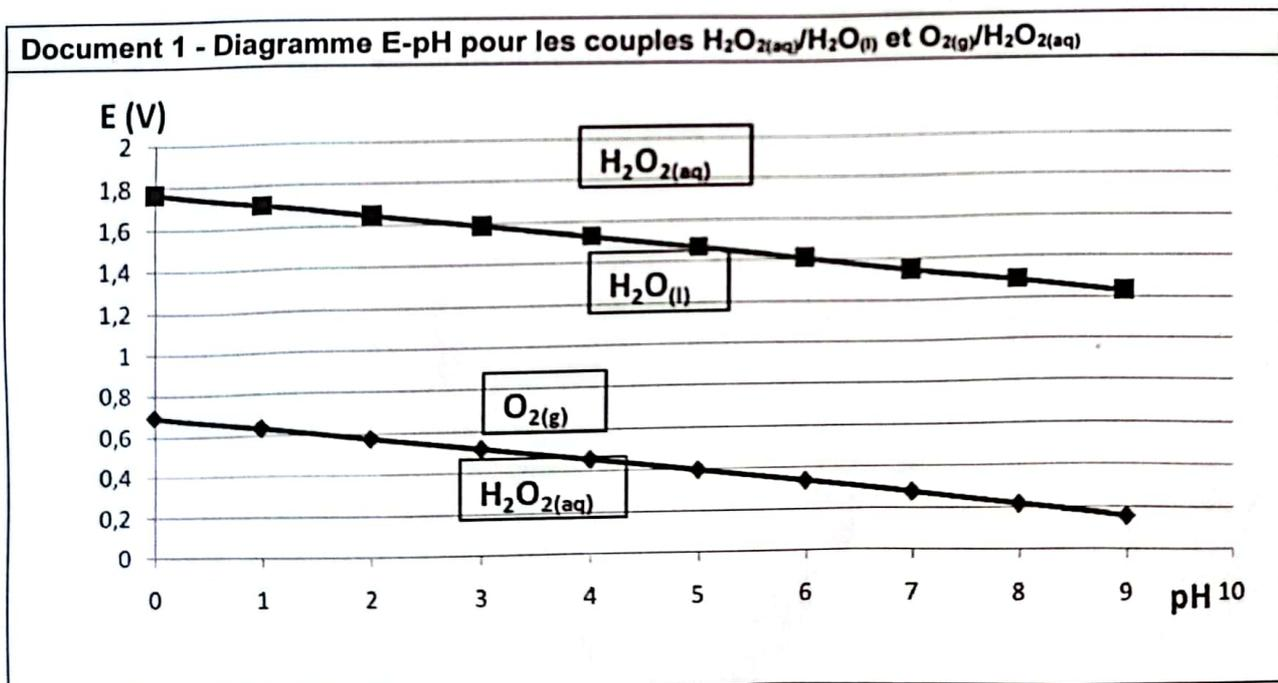
**Q55.** En déduire que  $H_2O_{2(aq)}$  n'est pas thermodynamiquement stable en solution et écrire alors la réaction susceptible de se produire dans une solution contenant  $H_2O_{2(aq)}$ .
