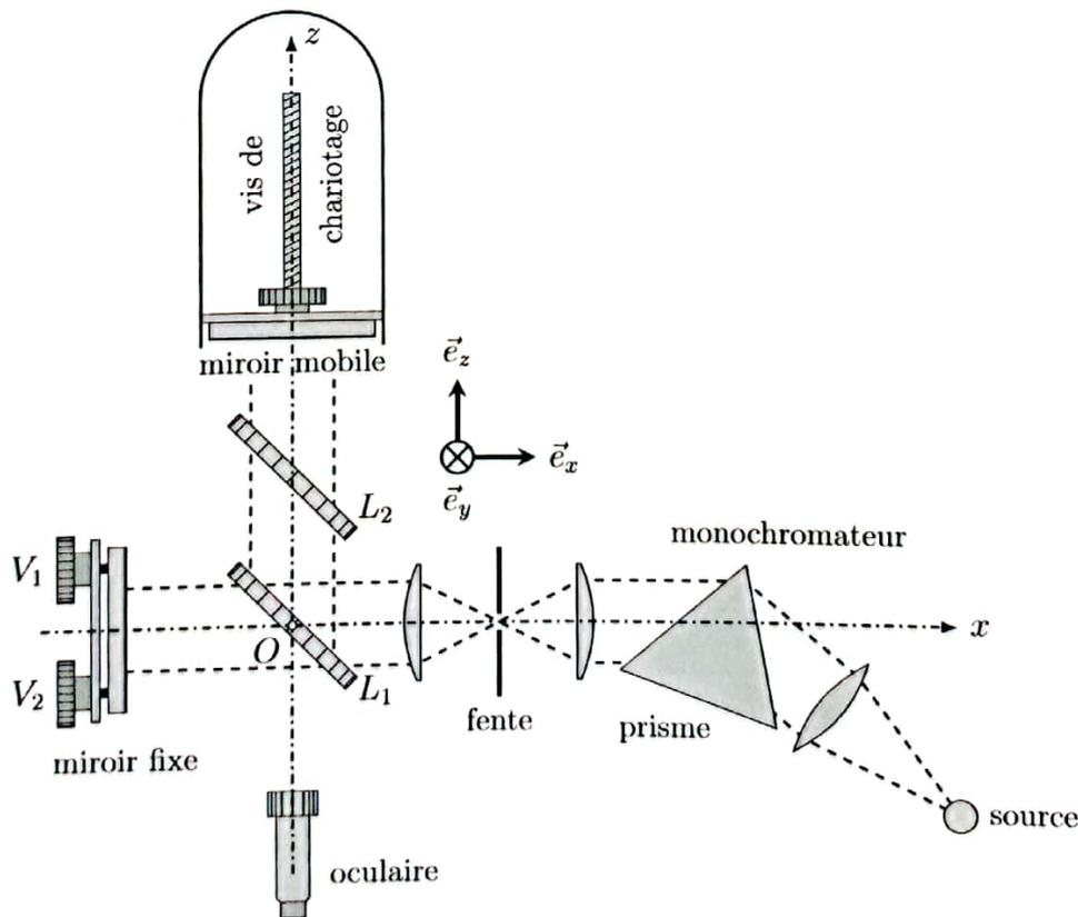
FIGURE 2 – Dispositif de mesure en spectroscopie interférentielle
