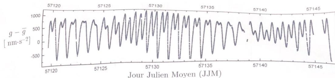
FIGURE 1 – Variation temporelle de l'intensité de la pesanteur
