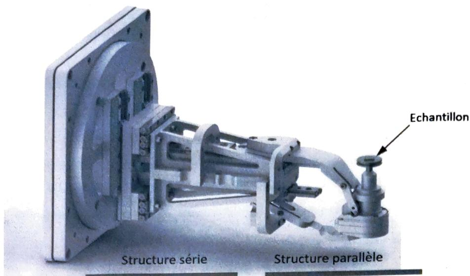
**Figure 2** : modèle tridimensionnel du goniomètre SmarGon
