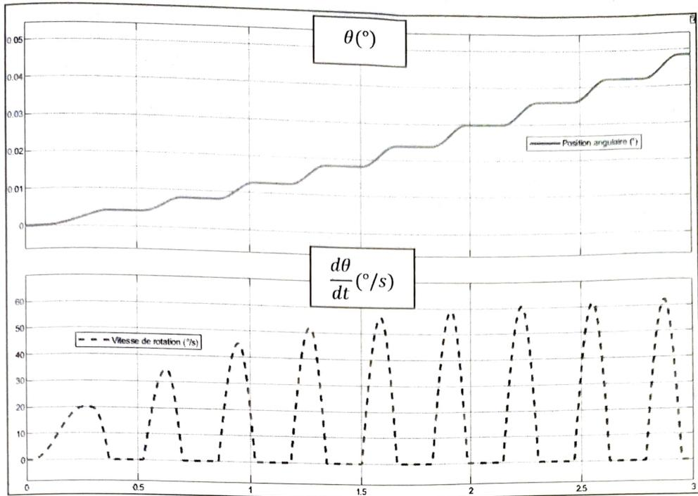
Figure 13 : position et vitesse de l'organe terminal en mode « approche » en fonction du temps (ms)
