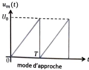
Figure 10 : pilotage de l'actionneur en mode d'approche
