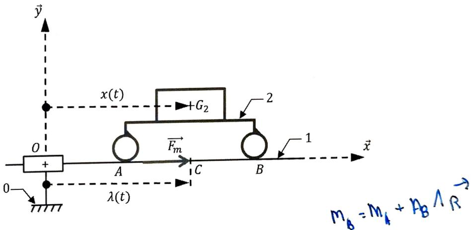
**Figure 12 :** modélisation du contact actionneur-coulisseau
