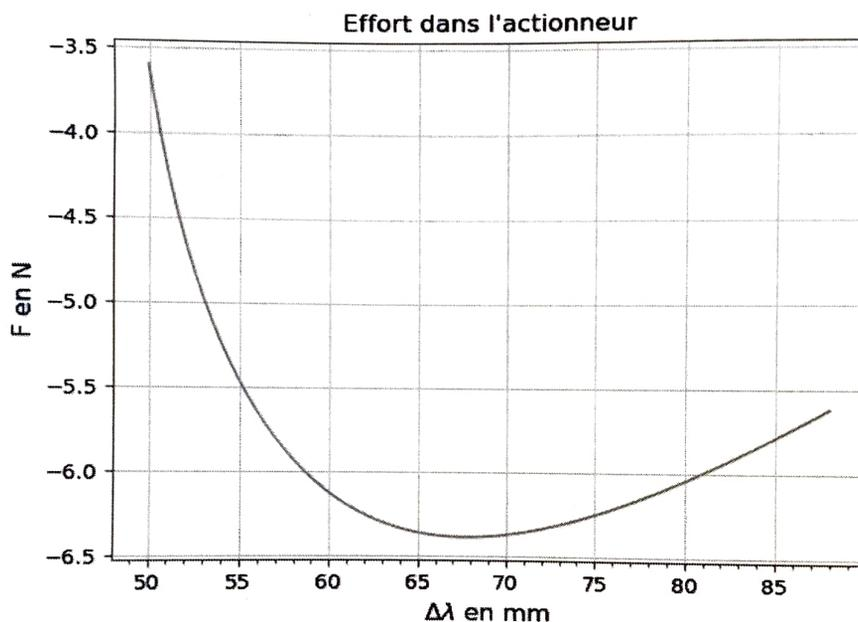
**Figure 6 :** effort dans l'actionneur  $F$  simulé en fonction de  $\Delta\lambda$
