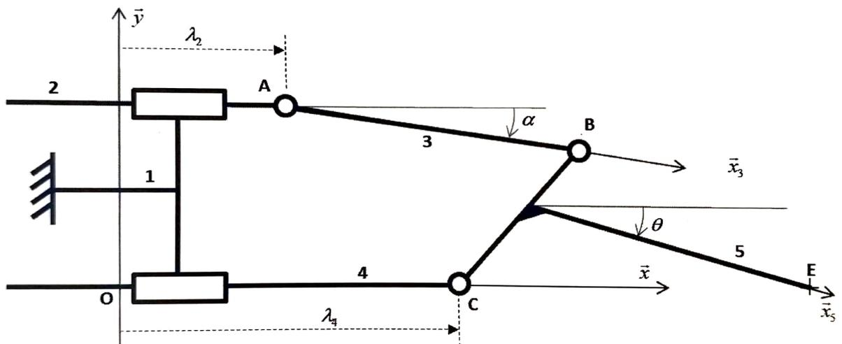
Figure 4 : Modèle cinématique plan de la structure terminale
