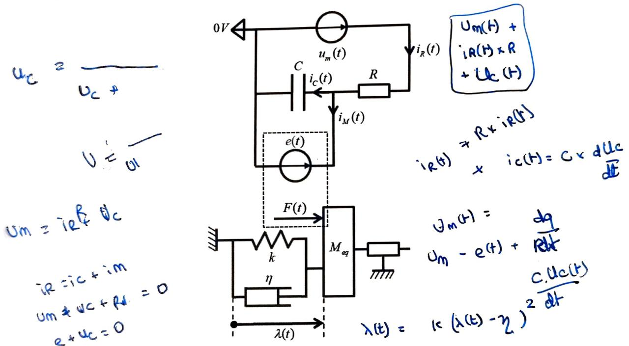
**Figure 7** : modèle électro-mécanique de l'actionneur linéaire piézoélectrique
