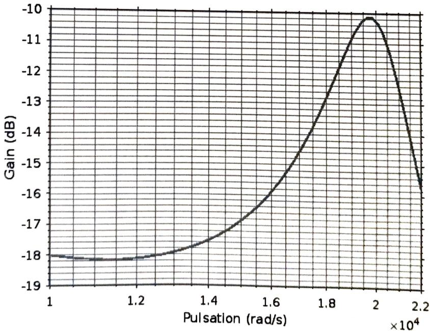
Figure 11 : diagramme de Bode du gain de  $H(p)$
