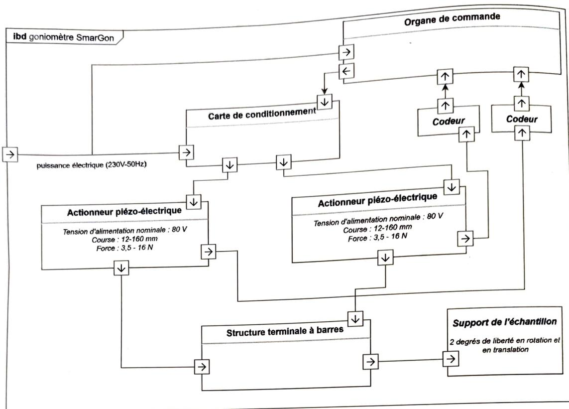
**Annexe 3 : Caractéristiques mécaniques des actionneurs piézoélectriques disponibles**
