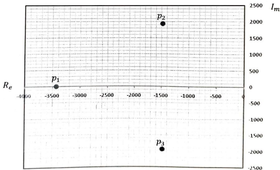
**Figure 8 :** pôles de la fonction de transfert  $H(p)$  dans le plan complexe
