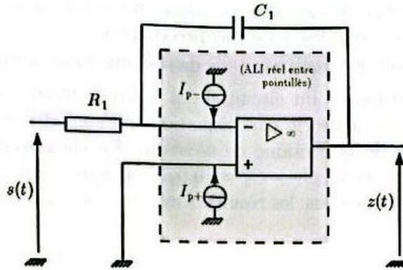
FIGURE 10 – Circuit avec la modélisation d'un ALI réel
