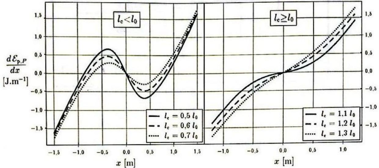
FIGURE 4 - Représentation graphique de la dérivée de l'énergie potentielle de pesanteur de  $P$
