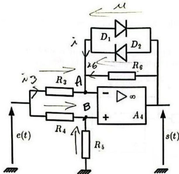
FIGURE 7 - Circuit à diodes
