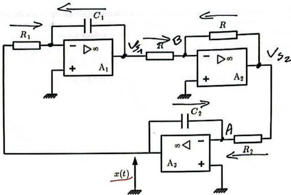
FIGURE 5 – Oscillateur électronique
