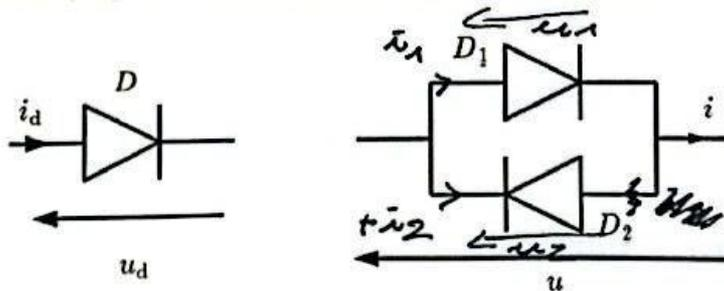
FIGURE 6 – Description d'une diode (à gauche) et d'un montage à diode en tête-bêche (à droite)
